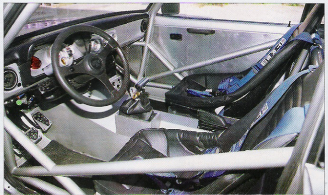
Sisusta on verhoiltu race tyyliin 1 mm alumiinilla.
